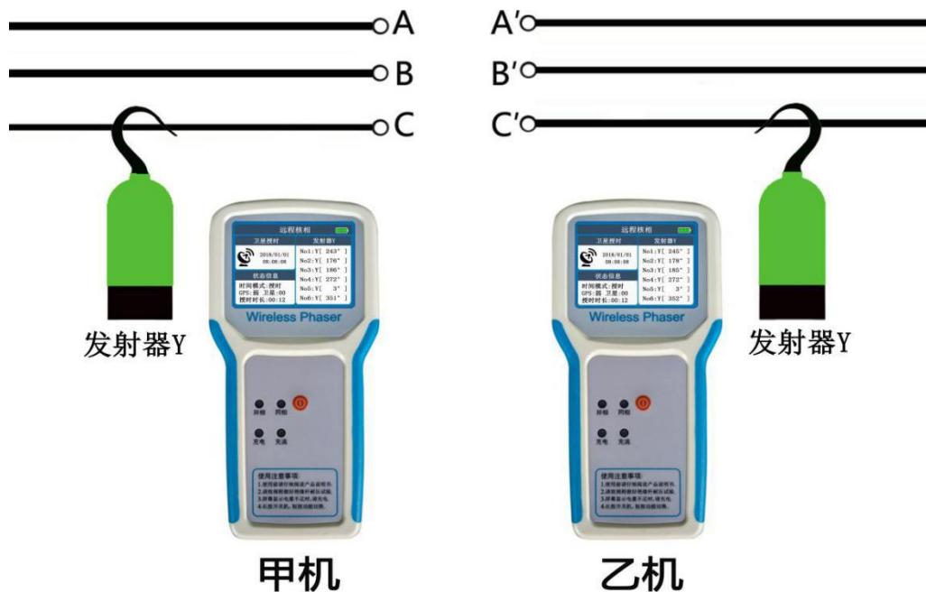
先将两台接收主机开机，切换到远程核相模式，在室外有GPS信号的地方完成授时，直至语音播报发射器无信号。再将分别将Y发射器接触所测带电线路，此时两台接收主机每10秒记录一组数据，No1到No6分别为每分钟的0s、10s、20s、30s、40s、50s的数据，对比甲乙两机同一编号的数据即可判断同异相。显示界面如下：
