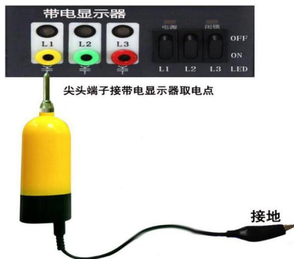
提示：由于带电显示器的主要作用是显示开关柜是否带电，并非标准的核相点，且不同厂家、不同时期、不同标准的带电显示器会产生不同程度的移相问题，且带电显示器 L1、L2、L3 与母线的对应关系不一定正确，若核相结果异常则应在一次线路上进行核相。
